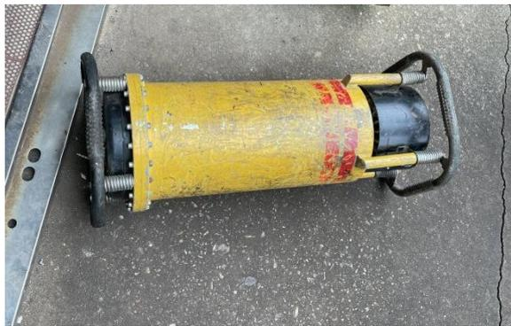
图 2-6 工业 X 射线探伤机实物图
